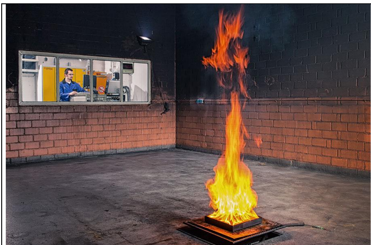
图 2-5 感烟灵敏度试验实验室效果图
