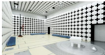
Messungen der gestrahlten Störaussendungen erfassen Frequenzen von 30 MHz bis 1 GHz, in bestimmten Fällen sogar noch höhere. Um die Konformität des Produkts zu bestätigen, müssen die Messergebnisse unter den Grenzwerten der maßgeblichen regulatorischen Vorgaben liegen.
